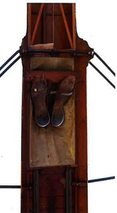
(6) Détail du skiff construit par Alexandre Lein. La barre où reposent les pieds n'est pas amovible, ce qui indique que le bateau a été fabriqué sur mesure pour son propriétaire. La foile fine au fond est une configuration unique. Elle permet de limiter l'entrée de l'eau dans le bateau.
